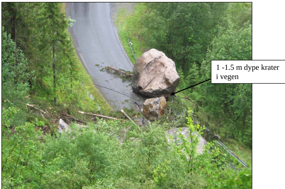
Foto 12: Blokker som har stanset på vegen med sidekanter 6-7 x 6 x 4 m \sim 150 \text{ m}^3 .
