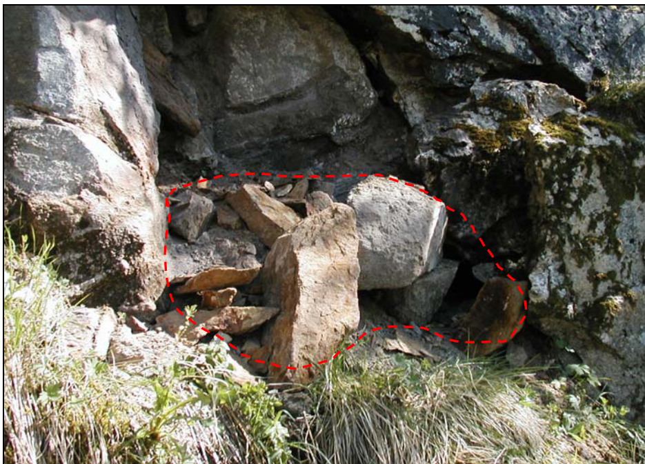
Foto 4: Løse blokker i terrengoverflaten rett nedenfor skrent ved løsneområdet.
