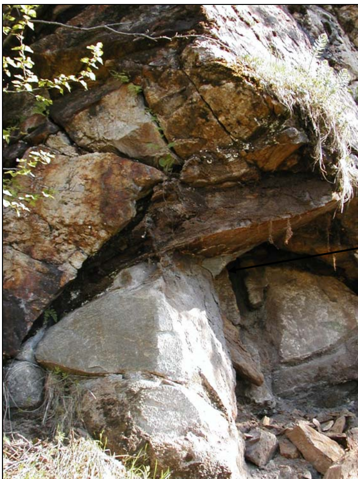
Foto 3: Løsneområde nederst i skrent for steinsprang 11.05.2004
