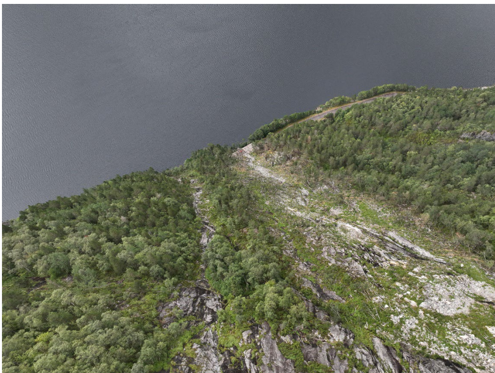
Figur 3 – Tydelig skredbane ned til skredoverbygget. Det ble under befaring ikke observert noe oppsamling av masse eller ustabile blokker som kan utgjøre en risiko for arbeidet.
