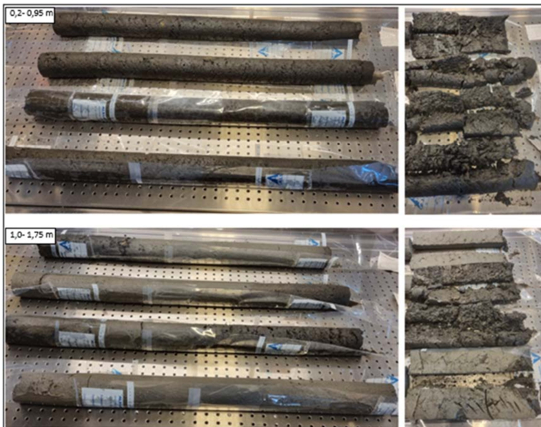
Figur 4-2: Sediment i dype prøver i 2239 til venstre. Representativt prøvemateriale fra sylindreprøver til høyre.
