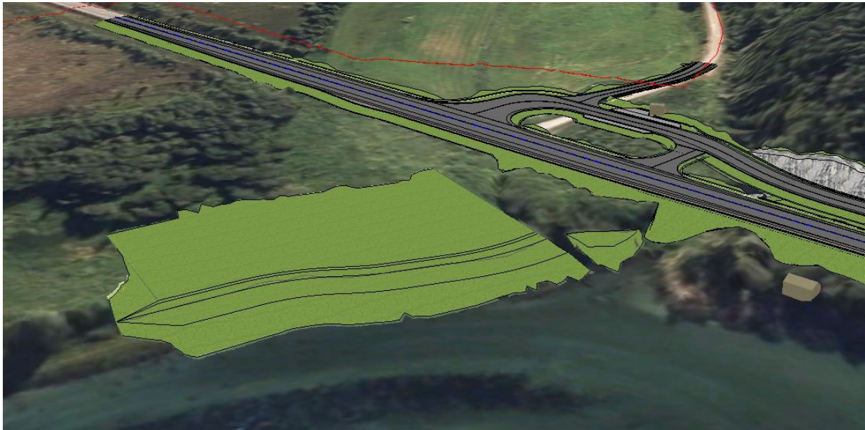
Figur 2. Fra Quadri, modellert motfylling og avlastning, til høyre strekkes motfyllingen fram til området med berg i dagen.
