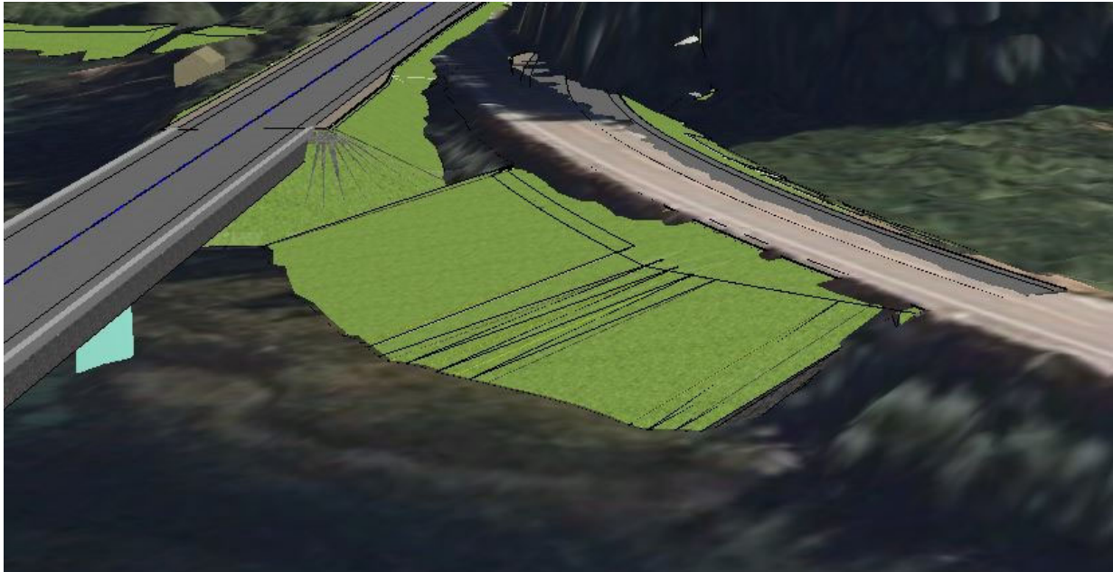
Figur 3. Fra Quadri, modellert skråningshelning 1:4 for dagens E6. Tatt mot sør.
