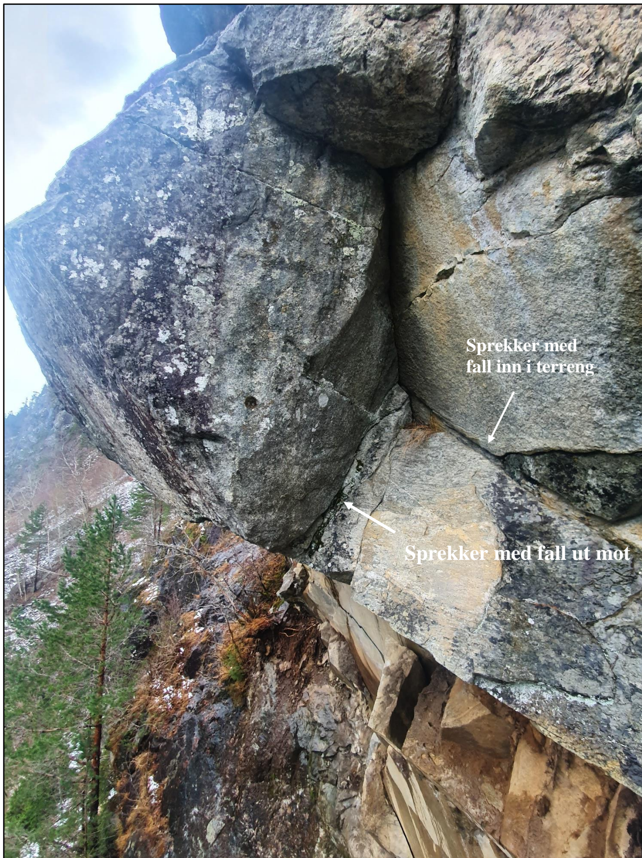
Figur4: Gjenværende blokker i løснеområde står med tyngdepunkt ut mot veg og utgjør et stort overheng. Blokkene er ikke tilstrekkelig stabile til å begynne arbeid på vegen. Løснеområdet må sikres med bolter. (Foto: Mesta fjellsikring)
