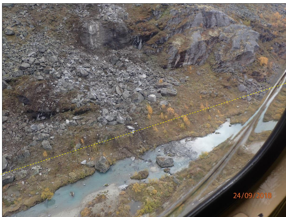
Figur 3: Nedre del av skredløpet. En kraftledning (gulstiplet) ble kuttet pga. treff fra skredblokk. Kun en liten del av skredet nådde helt ned til dalbunnen, se ferske lysegrå blokker i ur og elv. Fylkesvegen befinner seg til høyre i bildet, omtrent under helikopteret. Det ble kun observert én blokk som hadde kommet nærme veg, etter å ha passert elv/dalbunn.
