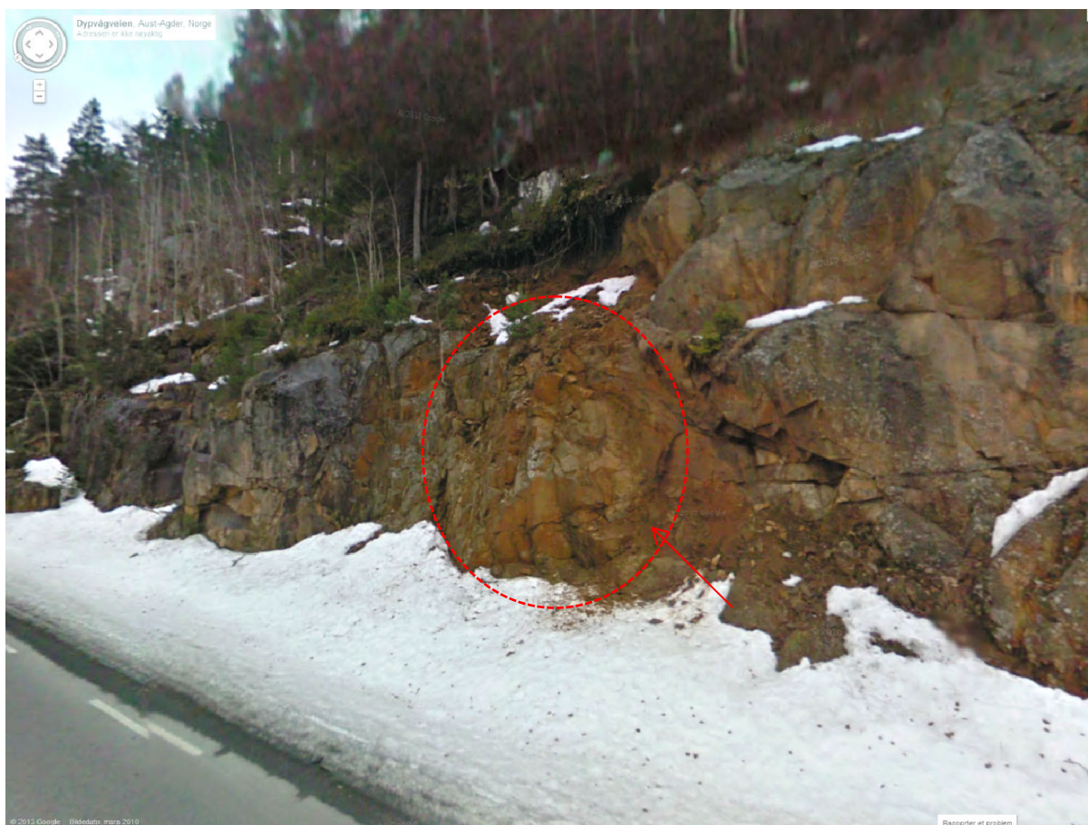
Figur 3: Rasstedet før hendelsen 13.05.2013. Det ustabile partiet er innringet med rødt. Avløsende sprekkeplan indikert med pil. (Kilde: Google streetview).
