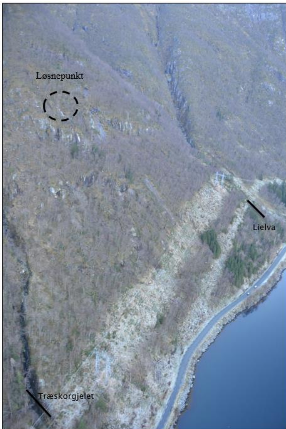
Figur 2: Løsnepunktet for steinspranget er vist med stiplet sirkel. Området mellom Lielva og Træskorgjelet er markert. Flere potensielle løsnepunkt og løse blokker ble observert i terrenget mellom disse gjelene.
