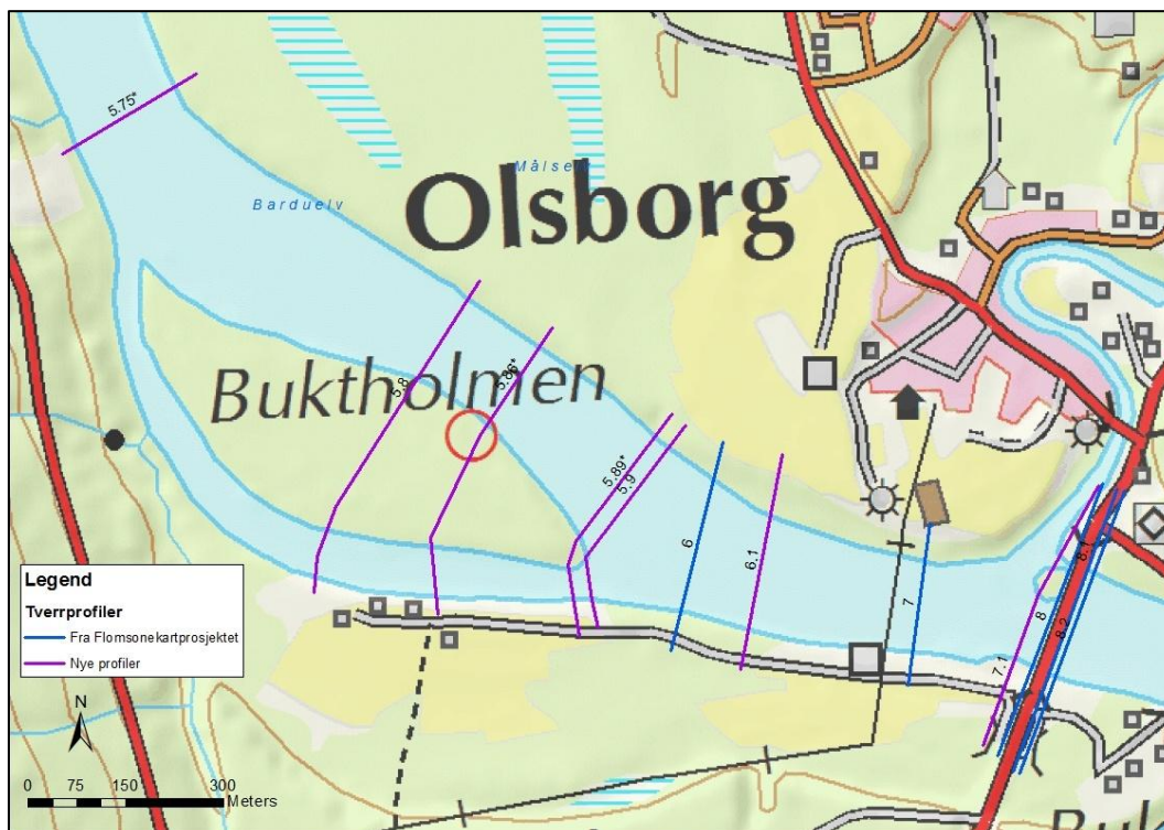
Figur 3. Plassering av profiler i elva ved Målselv bru. Profilene er nummerert fra nedstrøms til oppstrøms. Profilnummer som er markert med * i kartet er interpolerte profiler, profil 5.86 er målt opp i flomløpet men interpolert i hovedløpet.
