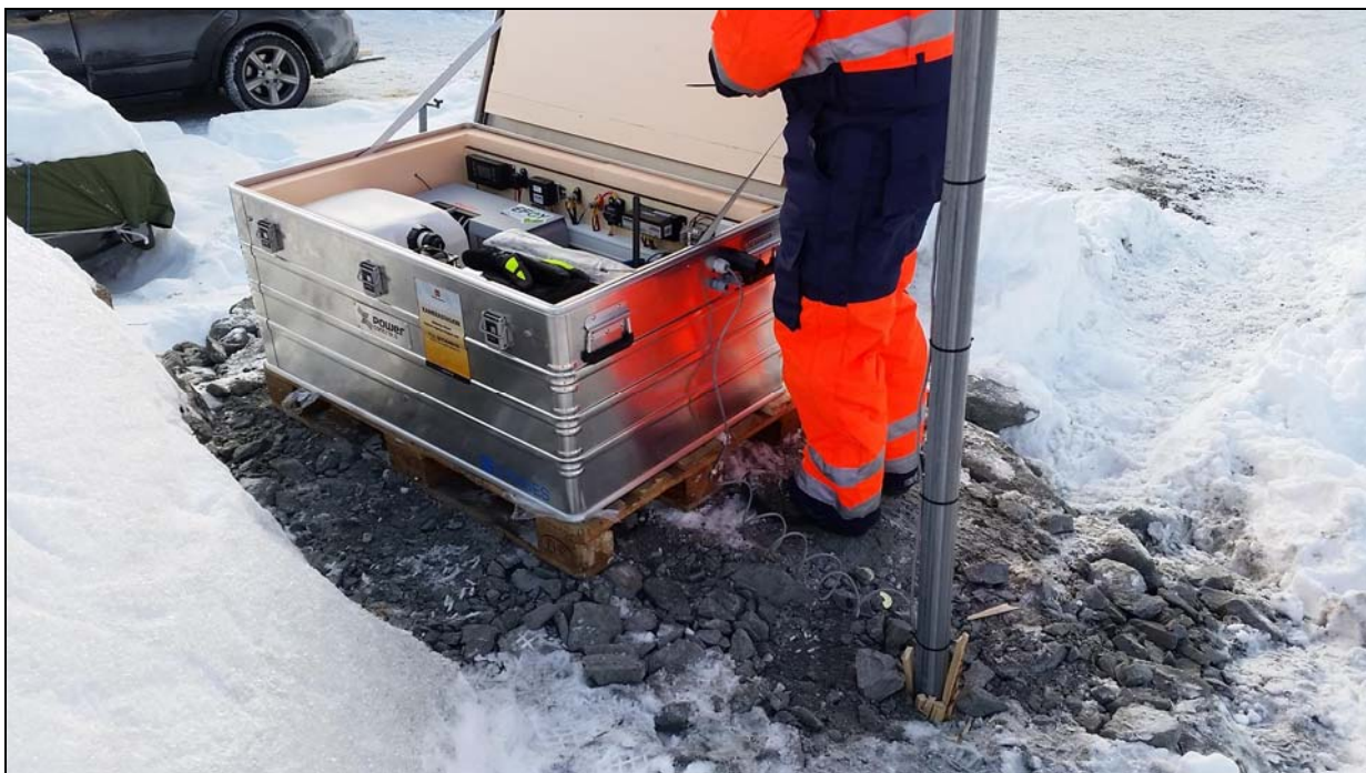
Figur 2. Brenselcellen med infrastruktur for dataoverføring montert ved E39 vinteren 2015/2016. Alt utstyret utenom selve kameraet får plass i Zargeskassen. (Foto: John Børre Veum).
