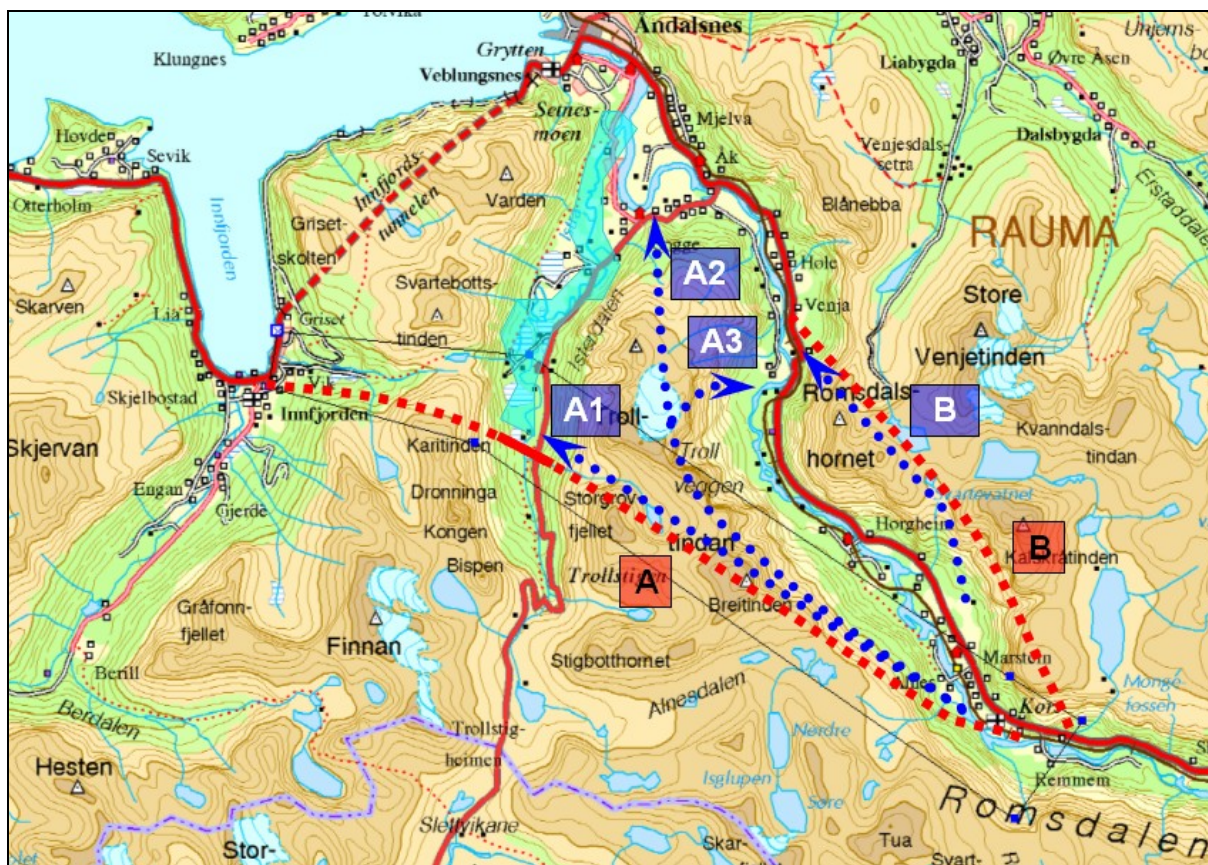
Figur 7: Aktuelle tunneløysingar for å drenere Rauma ved ei eventuell oppdemming. Blå stipla linje er reine dreneringstunnelar, medan raud stipla linje viser kombinasjonsløysingar med eventuelle vegtunnelar.
